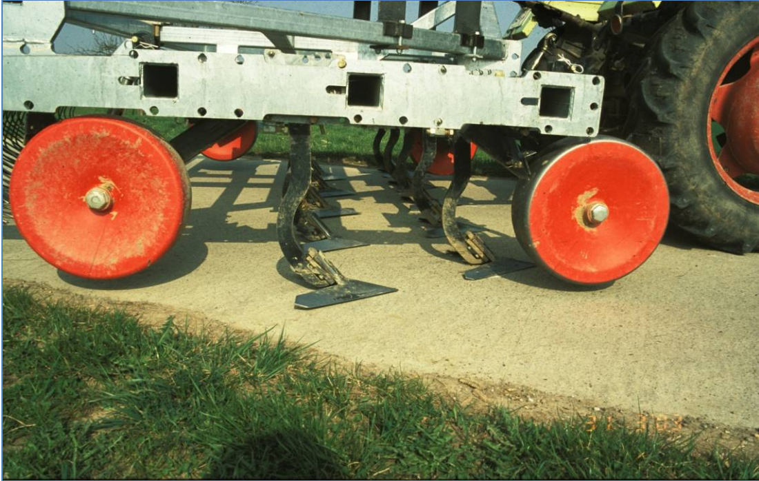
Unités de scalpage installées sur le semoir Éco-Dyn (pattes d'oies très larges).
